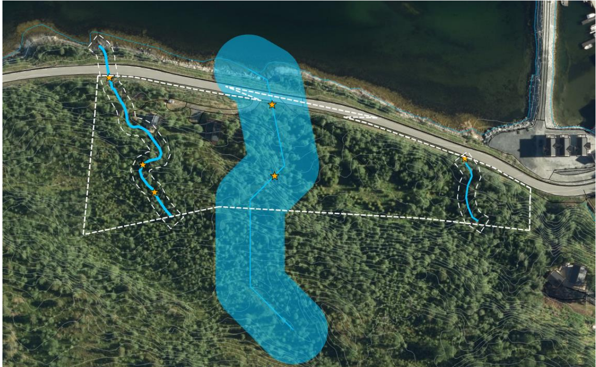
Figur 26 Modellert aktsomhetsområde for flom langs midtre bekk. Aktsomhetsområdet er gitt ved 20 meter på hver side av bekkene. Bekkene mot vest og øst har ikke flomvurderinger, men en byggegrense på 5 meter. Stjerner angir kritiske punkt.
