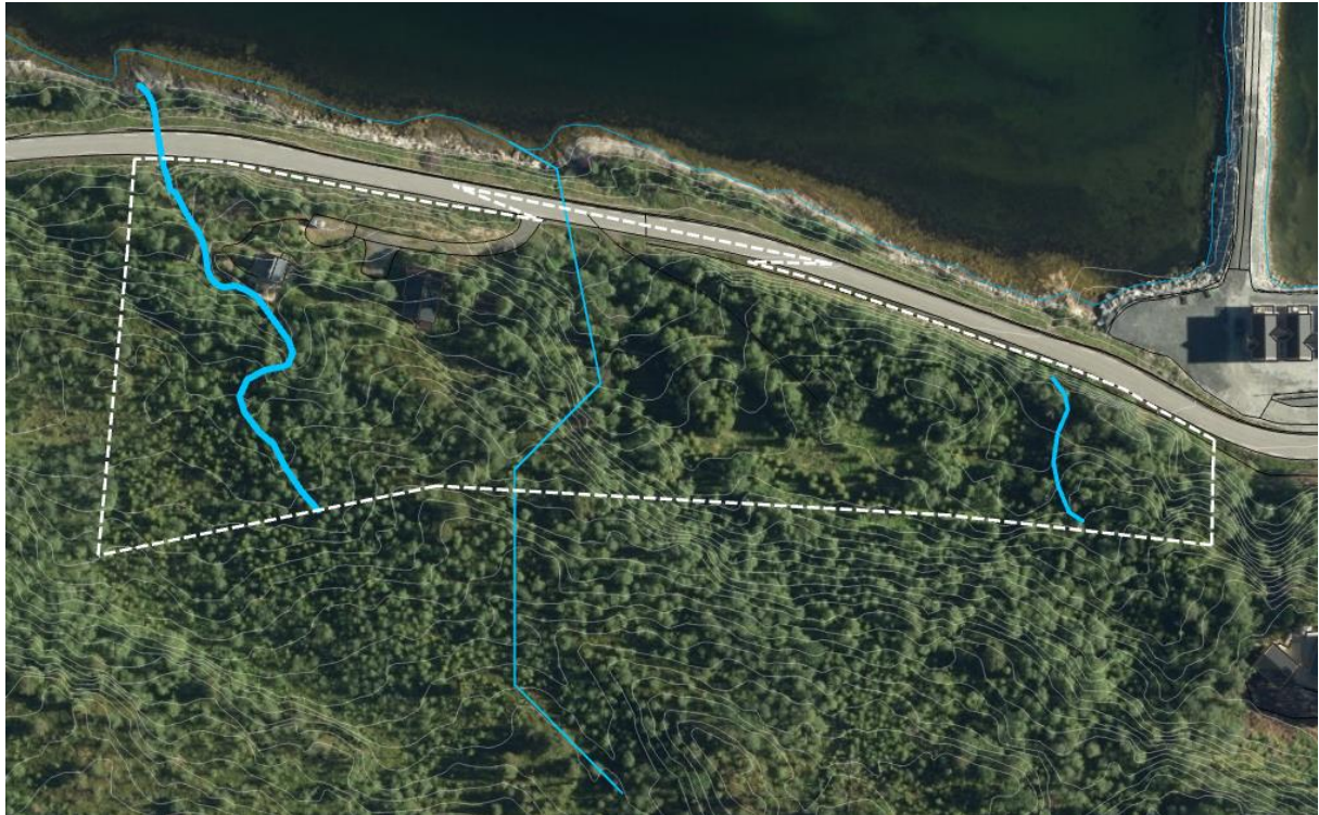
Figur 25 Registrerte og kartfestede bekkeløp under befaring i mai 2023. Observert størrelse på bekkene er illustrert ved tykkelse på bekkeløpet. Bekk i vest har størst vannføring, dernest bekk i øst og bekk i midten.
